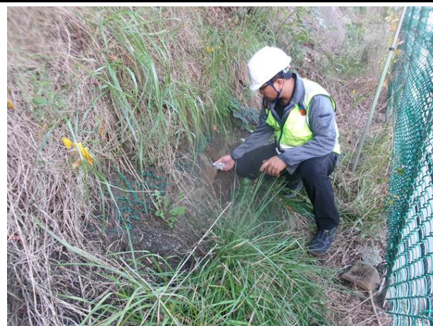
절리면 경사/경사방향 측정
